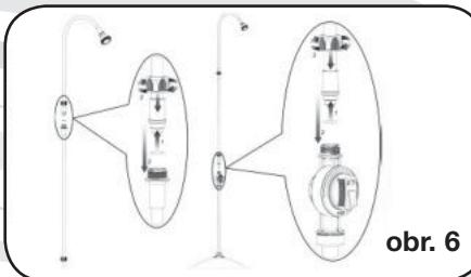
Přidržte plášť nádrže tak, že jí opěte o jednu ze třech plastových nožiček (viz.Obr. 3) a zašroubujte kolenovou spojku s kruhovou maticí na výčnívající závit černé tyčky až na doraz, aby jste tyčku upevnily (kolenová spojka se volně otáčí).
