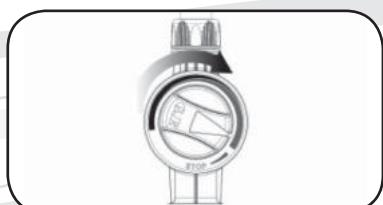
Před použitím nastavte ventil na směšování do polohy pro spuštění studené vody. Postupným otáčením ventila přidávejte teplou vodu až na požadovanou teplotu.
