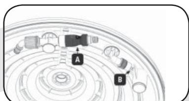
Před montáží vždy zkontrolujte, že je nainstalován reduktor tlaku (A) a pojistný ventil (B).
