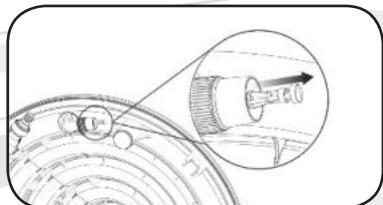
Pravidelně kontrolujte správnou činnost pojistného ventila popotáhnutím a pozvolným uvolněním otočného ovladače, aby jste zabránili tvorbě vodního kamene. Mohlo by dojít ke ztrátě vody.
